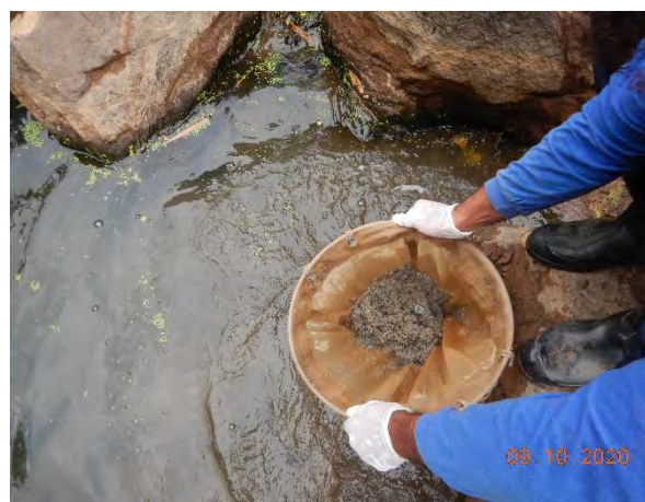
Fotos 3.2.3-1 e 3.2.3-2. Coleta de invertebrados bentônicos com pegador Petersen e lavagem do sedimento em campo.
