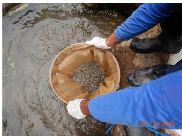
Foto 15 – Lavagem de sedimento para avaliação dos invertebrados bentônicos (Data:09/10/2020)
