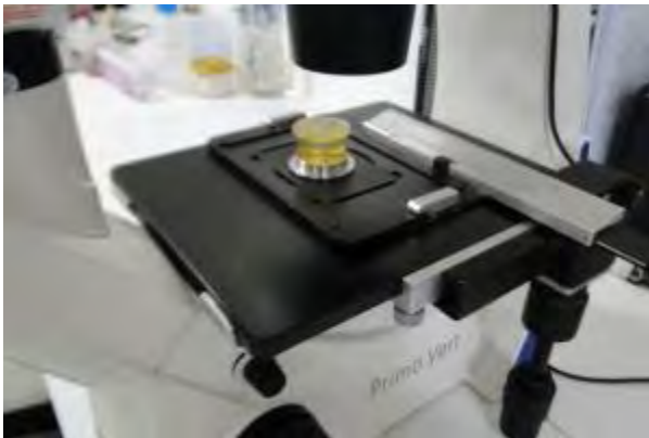
Fotos 3.2.1-1 e 3.2.1-2. Amostra na câmara de sedimentação de Utermöhl e contagem do fitoplâncton em microscópio invertido.
