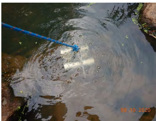
Fotos 3.2.3-1 e 3.2.3-2. Coleta de invertebrados bentônicos com pegador Petersen e lavagem do sedimento em campo.
